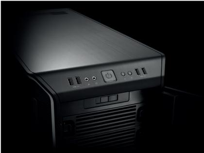
**Port frontal IO:** La commande manuelle du ventilateur prend en charge jusqu'à 3 PWM et 3 ventilateurs à 3 broches. Sont également intégrés : 2 ports USB 3.0, 2 ports USB 2.0 et des prises audio jack HD.
