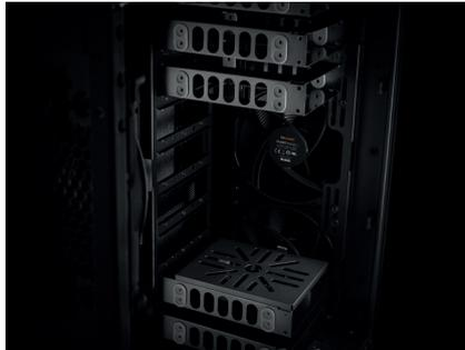
**Disques durs:** De multiples possibilités d'installation sont présentes grâce à des emplacements repositionnables. Prise en charge possible : jusqu'à 7 disques durs, 15 SSD et 2 lecteurs optiques.
